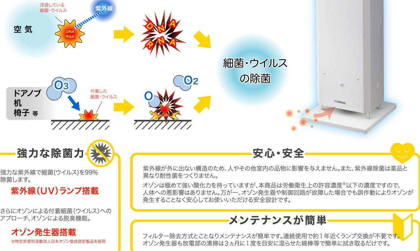
※労働衛生上のオゾン許容濃度(8時間/日 日本産業衛生学会より)は0.1 ppm以下、室内使用機器の許容濃度(日本空気清浄協会より)は、最高0.1 ppm、平均0.05 ppmとすることが勧告されています。
